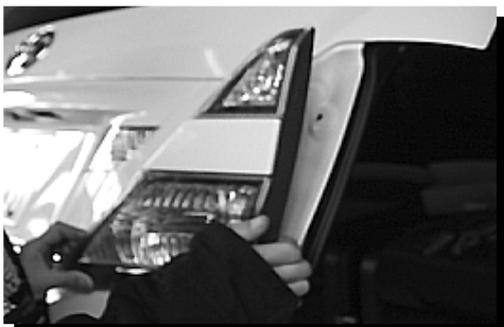
クリップ、ピンなど破損しないよう注意しながら、右斜め後ろに引いて外します。
