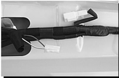
写真の様にハイマウントストップランプのプラス線(緑線)を見つけください。テスターにてブレーキを踏んだときに12V流れるかどうかの確認を必ず行い、製品の赤線をエレクトロタップにて結線してください。
